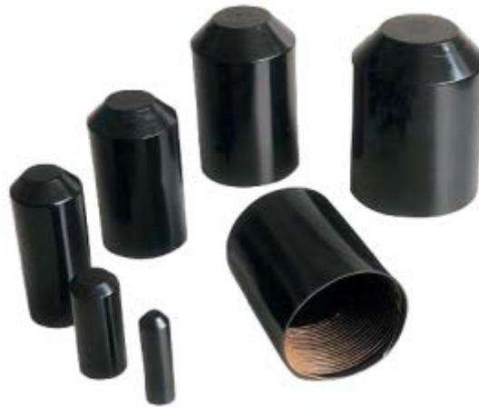
Al aplicar una temperatura superior a los 125° C los capuchones se contraerán alcanzando un diámetro predeterminado, permitiendo además que fluya el adhesivo termoplástico para proveer un sello estanco al conjunto.
