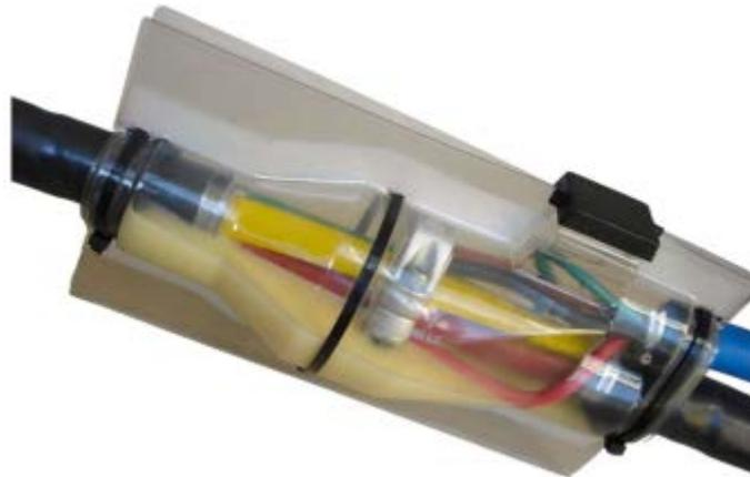
El conector dentado posee identificado en forma indeleble las secciones de cables que puede conectar, así como la posición del neutro. El cuerpo sirve de soporte mecánico y está aislado de las partes conductoras. La cubierta exterior del empalme es de material plástico rígido y transparente.
