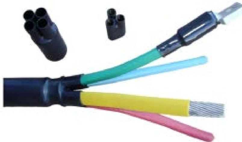
Los kits contienen una bota recubierta interiormente con adhesivo termoplástico que al aplicarle calor fluye y asegura el sellado evitando el ingreso de agua y humedad, la bota divide los cables multipolares en 2, 3 o 4 conductores unipolares. El conjunto también contiene tubos termocontraibles con adhesivo que proveen la aislación y el sellado hermético de los terminales metálicos de las venas del conductor.
